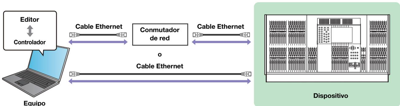
**NOTA** Si conecta el equipo al M7CL directamente, utilice un cable cruzado.
