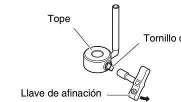
5. Asegure el tope en su posición. Con el tope en contacto con la superficie inferior de la cubierta de tornillo, apriete el tornillo de llave del tope con una llave de afinación.
