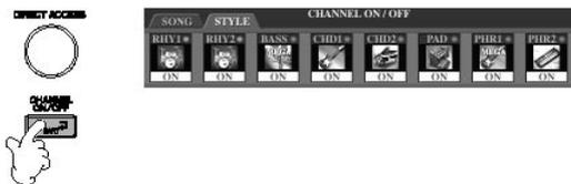
2. Pressione os botões [1]–[8] para acionar os canais. Para escutar só um instrumento, pressione e segure o botão apropriado para o canal ser fixado em SOLO. Para cancelar SOLO, aperte simplesmente o botão do canal apropriado novamente.
