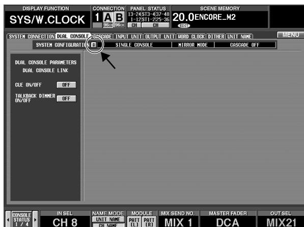
A continuación aparecerá la ventana SYSTEM CONFIGURATION. En el área OPERATION MODE SELECT de esta ventana puede seleccionar el modo de funcionamiento del sistema PM1D.
