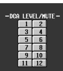
Mientras esté activado el botón DCA LEVEL/MUTE, el ajuste de tiempo de fundido del grupo DCA se ignorará y no podrá utilizarse el fundido automático ni el fundido manual.
