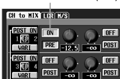
La señal enviada desde un canal de entrada a un bus MIX puede activarse o desactivarse con esta operación. Si desplaza el cursor a este parámetro y pulsa los interruptores [SHIFT] + [ENTER], aparecerá la siguiente ventana emergente:
