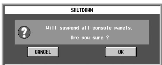
3. Pulse el botón OK. A continuación aparecerá la siguiente pantalla y se oscurecerán los diodos del panel. En este momento ya puede apagar la mesa de mezclas con seguridad. Si pulsa el botón CANCEL volverá a la pantalla de menús.
