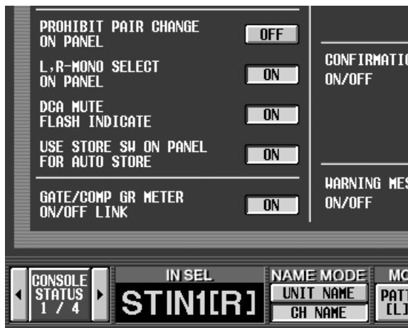
3. Para ejecutar la función de almacenamiento automático, pulse el interruptor **[STORE]** del bloque **SCENE MEMORY** dos veces.
