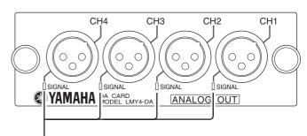
The green LED lights up at 34 dB before clipping. クリッピング手前34dBで緑色LEDが点灯
