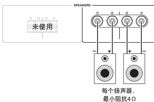
桥接方式的连接：
