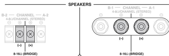
在桥接方式中，通道A-1, B-1和A-2, B-2的负 (⊖) 极塞孔不使用。
