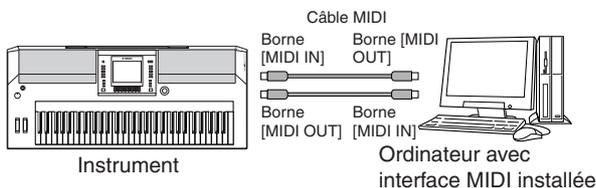
La deuxième possibilité de connexion passe par une interface MIDI externe séparée reliée à l'ordinateur via un port USB ou un port série (borne du modem ou de l'imprimante). A l'aide de câbles MIDI standard, branchez la borne MIDI OUT de l'interface externe à la borne [MIDI IN] de l'instrument et branchez la borne [MIDI OUT] de l'instrument à la borne MIDI IN de l'interface.
