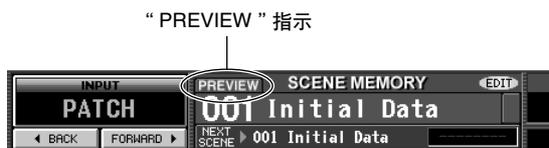
在 PREVIEW 模式中，操作旋钮、编码器和其它控制器（不包括 PM5D 型号的 TALKBACK 部分、CUE /MONITOR 部分和 AD IN 部分）将不会影响音频信号处理。
