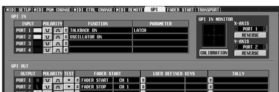
如果为 FADER START 参数和 FADER STOP 参数指定了相同端口，则 GPI 画面的 FADER START 字段将被分配至与该端口对应的通道（推子模式 = FADER TALLY）。（反之亦然。）
