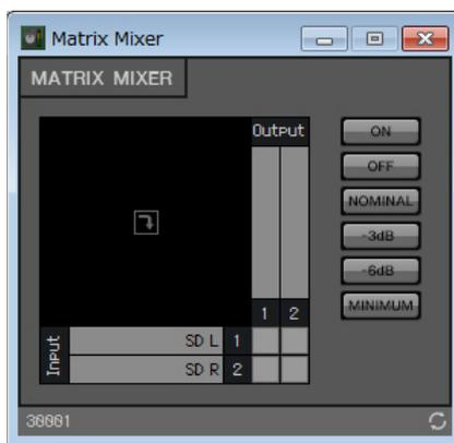
6. 进行设置，使输入 1 和 2 输出到输出 1，对输出 1 输入“SD”，然后单击右上角的 [x] 按钮关闭组件编辑器。
