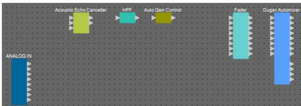
**2.** 拖放“HPF”和“Auto Gain Control”端口之间的组件进行连接。
