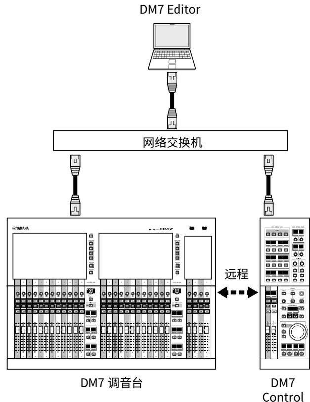
您可以在网络上远离 DM7 调音台的其他位置使用本产品 (通过网络电缆连接)。
