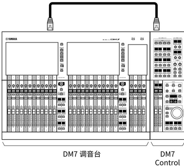
您可以使用接合金属支架将本产品连接并固定到 DM7 调音台。(“与 DM7 调音台连接” → 第 12 页)
