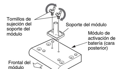
2. Coloque el soporte del módulo dentro de la abrazadera del soporte y apriete el tornillo abrazadera para asegurarlo en su sitio.
