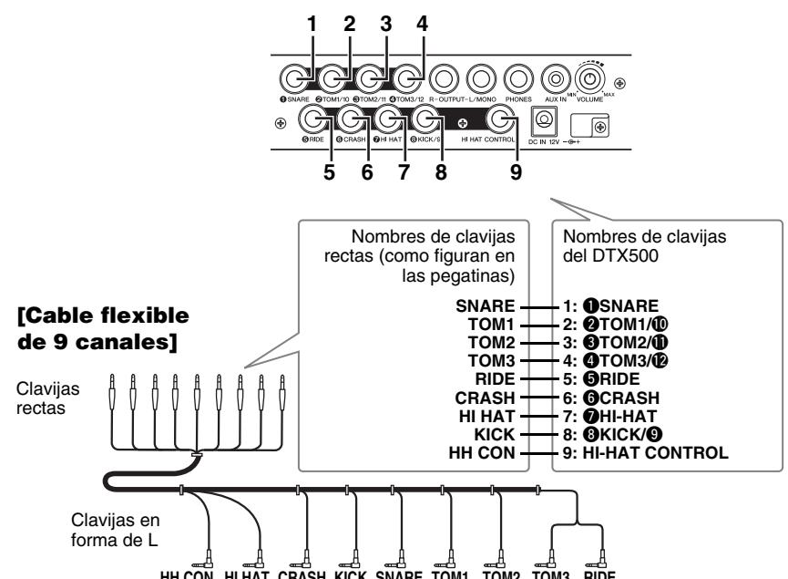
2. Conecte las clavijas en forma de L del cable flexible de 9 canales a los pads correctos.
