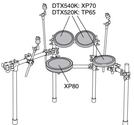
2. Monte el pad de caja en la abrazadera de varilla del bastidor. Como se muestra a continuación, compruebe que la sección de varilla está totalmente insertada en el orificio de montaje del pad y después apriete bien el tornillo abrazadera.
