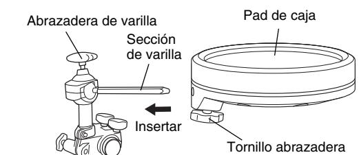
3. Si es preciso, utilice los tornillos abrazadera A a E para ajustar la altura y el ángulo del pad de caja. Al hacerlo, asegúrese de ajustar un tornillo cada vez (es decir, afloje un tornillo, ajuste el pad y vuelva a apretar antes de aflojar otro tornillo).
