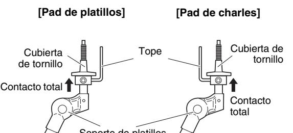
6. Coloque en el soporte de platillos una de las almohadillas de fieltro retiradas en el paso 2.
