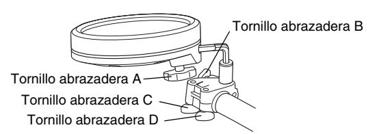
3. Si es preciso, utilice los tornillos abrazadera A a D para ajustar la altura y el ángulo de cualquiera de los pads. Al hacerlo, asegúrese de ajustar un tornillo cada vez (es decir, afloje un tornillo, ajuste el pad y vuelva a apretar antes de aflojar otro tornillo).
