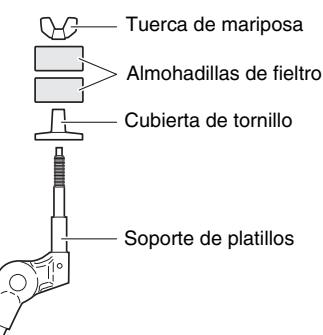
5. Asegure el tope en su posición. Con el tope en contacto con la superficie inferior de la cubierta de tornillo, apriete el tornillo de llave del tope con una llave de afinación.
