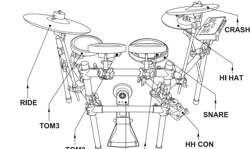
3. En el caso de los pads de caja y de timbal, enrolle los cables alrededor de los sujetacables para evitar que se desconecten.
