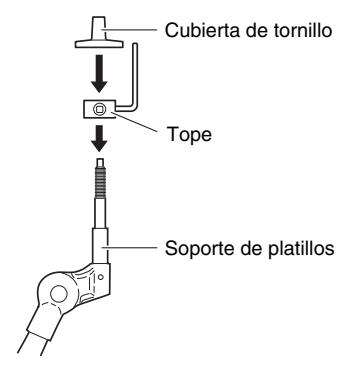
\* Al montar la cubierta de tornillo, gire hasta llegar al tope.
