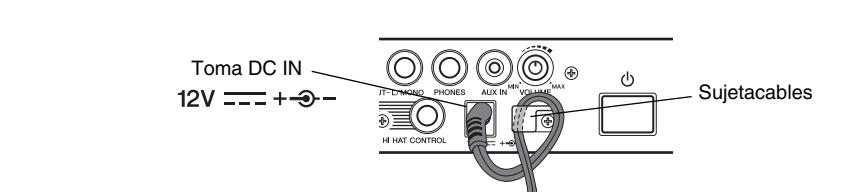
2. Utilice las bandas de cable para fijar los cables al bastidor, tal y como puede verse a la derecha. (O)
