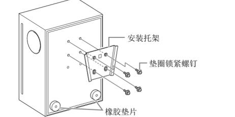
5 将两个橡胶垫片安装到音箱底边。确保垫片尽量靠近外缘；否则会影响下一步中在托架底座上的安装。安装时要将橡胶垫片粘紧。
