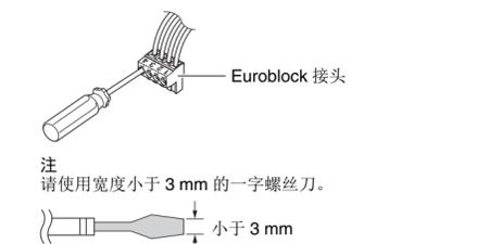
3（仅限 VXS10ST/VXS10STW）将 5 针 Euroblock 接头插入 TRANSFORMER SETTINGS 插孔。
