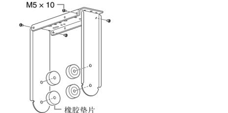
2 确保 U 型托架的宽度符合音箱的宽度。
