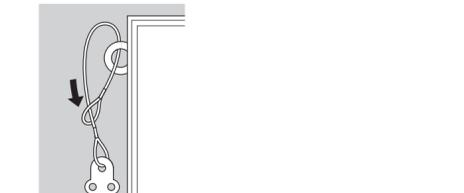
3 将安全绳上的托架固定到墙壁上。
