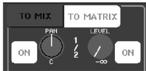
Para um canal de entrada INPUT, o botão direito ajusta o nível de mandada comum para os dois buses MATRIX, e o botão esquerdo ajusta o pan entre os dois buses MATRIX. Girando o botão esquerdo de TO MATRIX SEND LEVEL para a esquerda faz aumentar a quantidade de sinal enviado para o bus MATRIX de número ímpar, e girando-o para a direita faz aumentar a quantidade de sinal enviado para o bus MATRIX de número par.
