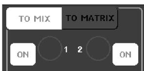
Se o bus MIX de destino da mandada for do tipo VARI, será mostrado o botão TO MIX SEND LEVEL na mesma cor que o encoder correspondente na seção SELECTED CHANNEL. Neste caso, você pode usar o encoder correspondente da seção ELECTED CHANNEL para ajustar o nível de mandada.
