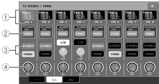
Aqui você pode ligar/desligar e controlar os ajustes de pan/balance do sinal enviado pelo canal MIX para o bus STEREO (L/R) e o bus MONO (C), em grupos de oito canais.
