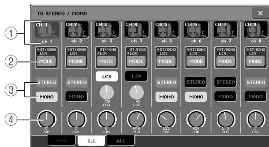
Aqui você pode controlar o estado ligado/desligado e os ajustes de pan/balance do sinal enviado dos canais de entrada para o bus STEREO (L/R) e o bus MONO (C), em grupos de oito canais.
