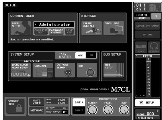
**2** Na parte superior esquerda da janela, pressione a tecla USER SETUP para acessar a janela *popup* USER SETUP.
