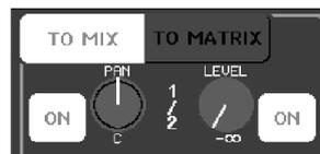
Para um canal de entrada INPUT, o botão da direita ajusta o nível de mandada comum aos dois buses MIX, e o botão da esquerda ajusta o pan entre os dois buses MIX. Girando o botão TO MIX SEND LEVEL da esquerda para o lado esquerdo faz aumentar a quantidade de sinal enviado para o bus MIX de número ímpar, e girando-o para o lado direito faz aumentar a quantidade de sinal enviado para o bus MIX de número par.
