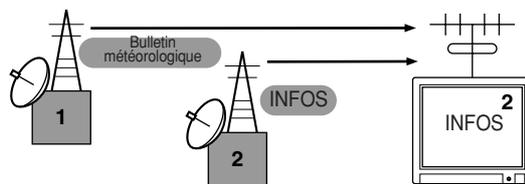
La norme MIDI fonctionne selon le même principe de base. L'instrument émetteur envoie des données MIDI à l'instrument récepteur sur un canal MIDI spécifique (MIDI Transmit Channel) via un câble MIDI unique. Si le canal MIDI de l'instrument récepteur (MIDI Receive Channel) correspond au canal de transmission, le son émis par l'instrument récepteur dépendra des données envoyées par l'instrument émetteur.
