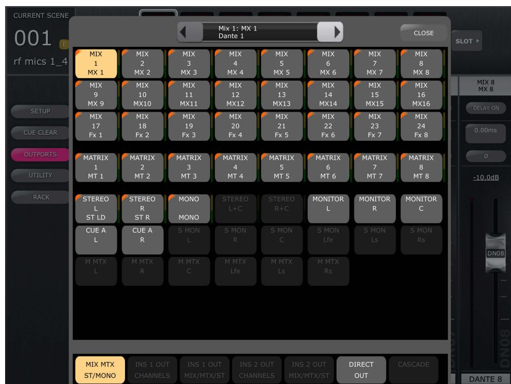
現在アサインされているパッチが存在する場合、パッチ情報がパッチボタングリッドのパッチ画面に表示されます。またパッチ画面の上部中央にある小さい画面の1行目にも表示され、2行目には、現在選択されている出力ポートが表示されます。
