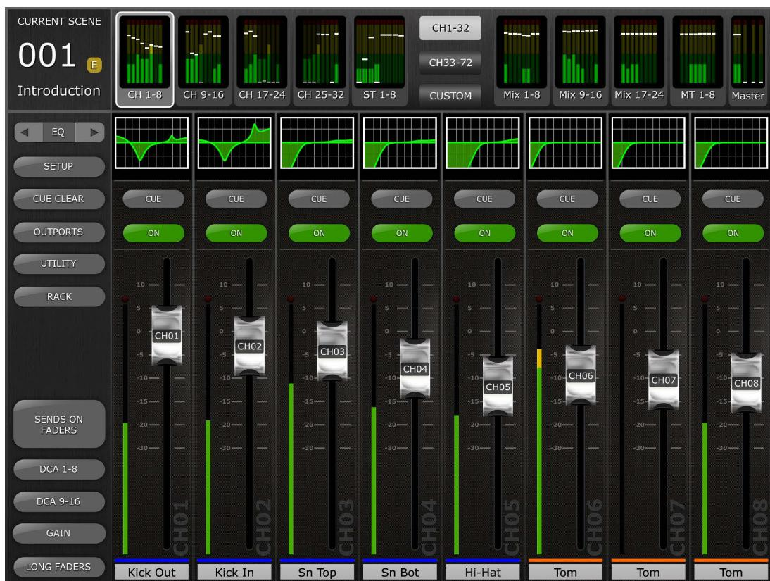
画面上部には、レベルメーターとフェーダーがブロック(mono インプットチャンネル 1-32、Stereo インプットチャンネル 1-8、MIX/MATRIX バス、Master Stereo/Mono バス)に分かれて表示されています。これを「ナビゲーション/メーターブリッジ」といいます。
