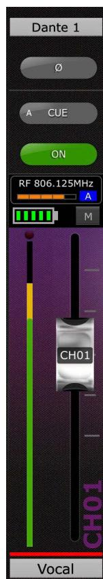
バッテリー充電状態およびミュート状態のインジケーターの上に、RF シグナルメーターとダイバーシティ方式で A と B のどちらを使用しているかが表示されます。
