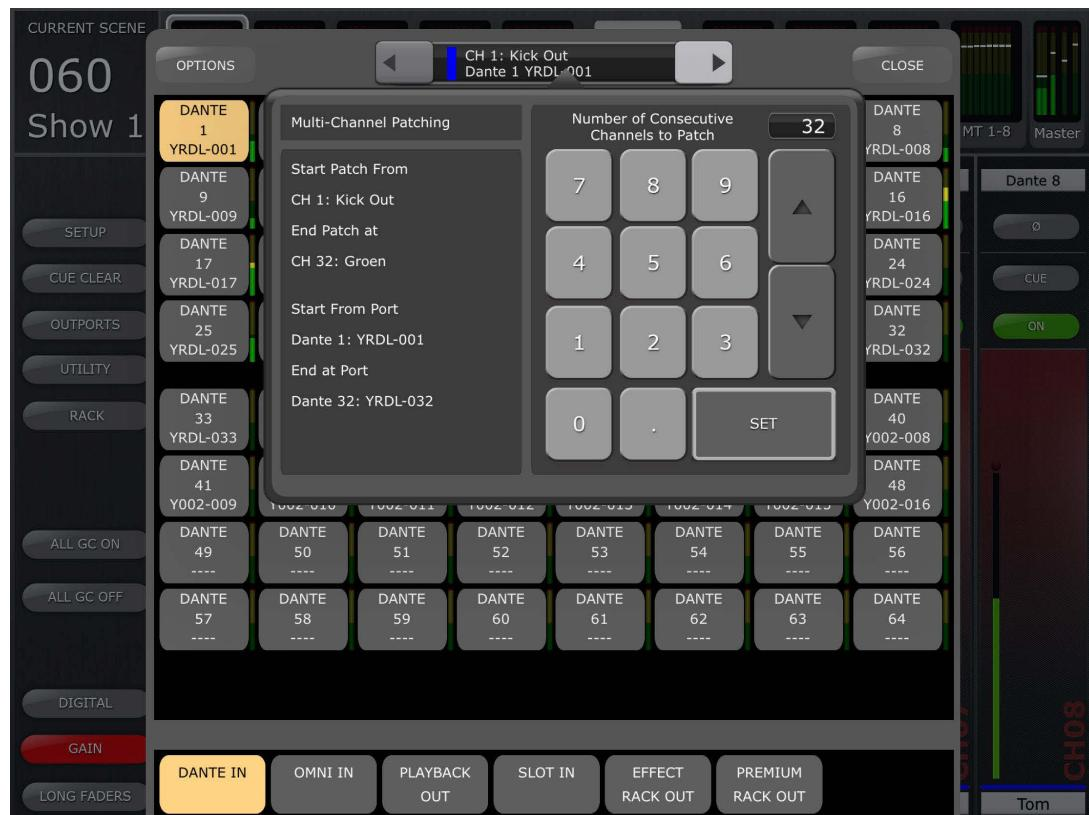
表示されたポップアップで、一度にパッチするチャンネル数を入力します。ポップアップの左側にはパッチの先頭と末尾のチャンネル、先頭と末尾の入力ポートが併せて表示されます。SET を押すと、実行されるパッチの概要と併せて確認のダイアログが表示されます。YES を押すとマルチチャンネルインプットパッチが実行され、NO を押すとポップアップに戻ります。
