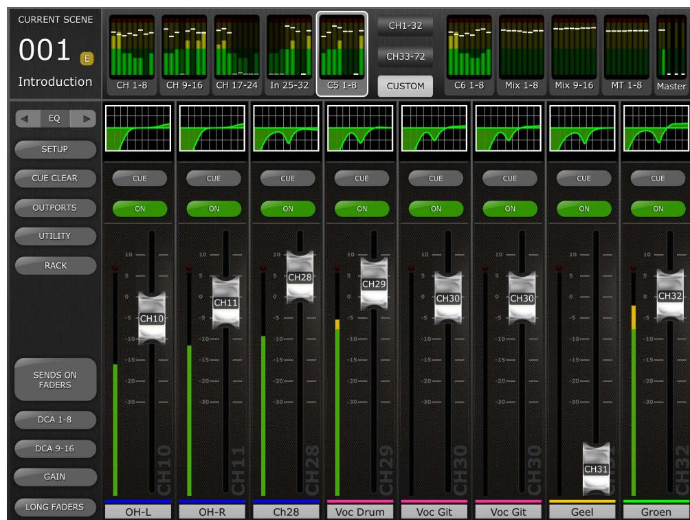
メーターブリッジブロックにフェーダーバンクを割り当てるには、フェーダーメーターブロックをポップアップリストが出るまで押し続けます。ポップアップリストには、接続されている CL シリーズの有効なすべてのフェーダーバンクが表示されます。フェーダーブロックに割り当てたいフェーダーバンクをタッチしてください。この操作を繰り返すことで、複数のフェーダーバンクをメーターブリッジブロックに割り当てられます。
