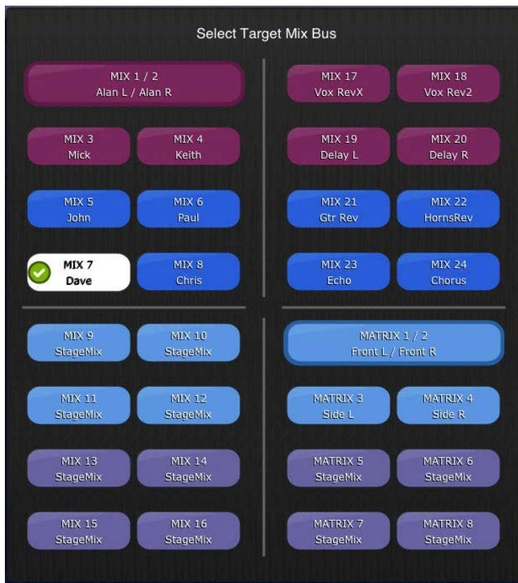
MIX 1-24 および MATRIX 1-8 から操作対象のバスを選択できます。チェックマークの付いた白いボタンが現在選択されている MIX です。ステレオペアに設定されている MIX はひとつの大きなボタンとして表示されます。
