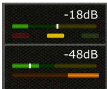
ダイナミクス 1 はサムネイルの上部に、ダイナミクス 2 は下部に表示されます。(アウトプットチャンネルはダイナミクス 1 だけです)
