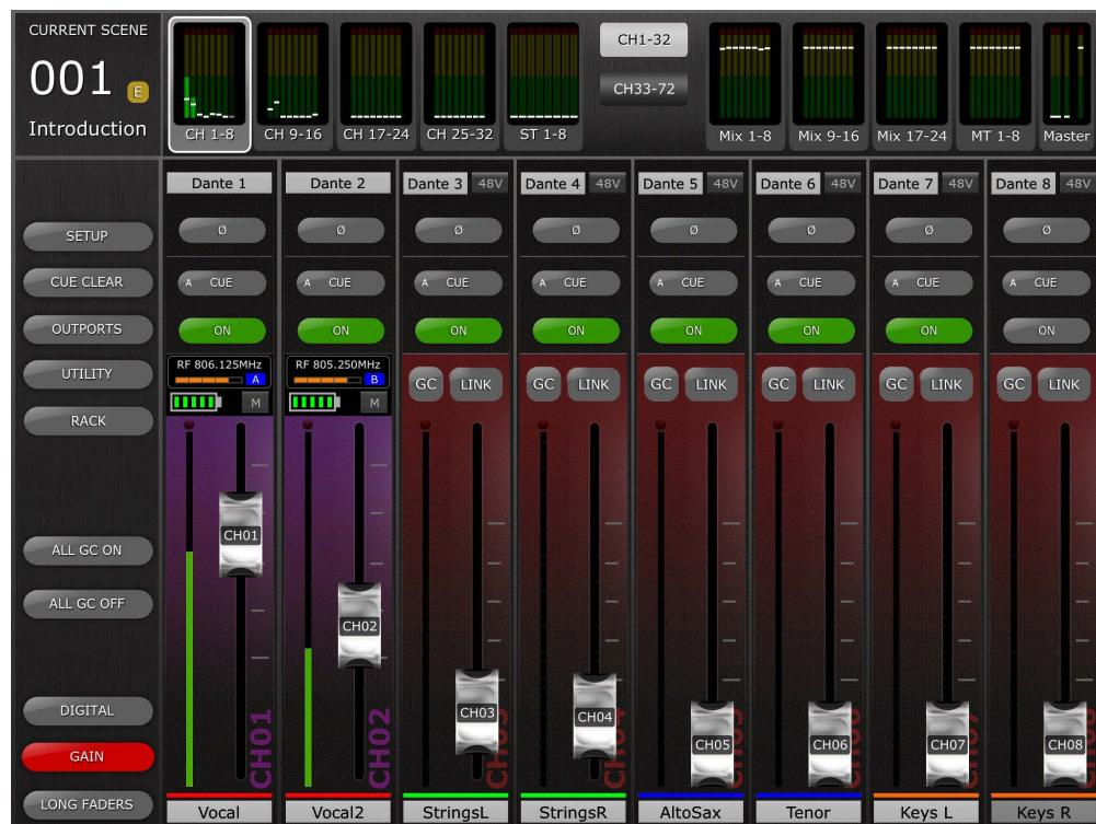
ワイヤレス受信機(RX)のチャンネルの出力ゲインは、フェーダーでコントロールします。ワイヤレス受信機が有効な場合、フェーダーの上に、ワイヤレスマイクの現在のバッテリー充電状態が表示されます。バッテリー充電状態表示部の右側には、受信機の音声出力のミュート状態が表示されます。アイコンを押すと、受信機のミュートまたはミュートの解除ができます。このとき、確認のポップアップが表示されます。
