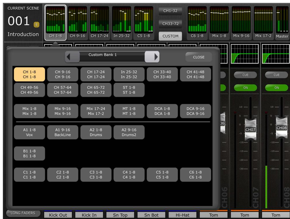
左右ナビゲーションボタンは、ポップアップリストを開いたまま他のメーターブロックに移動するために使用します。フェーダーバンク割り当てをキャンセルするには、ポップアップリスト以外のところをタッチするか、ポップアップリスト右上のクローズボタンをタッチします。
