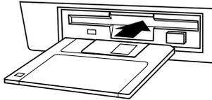
Introduisez la disquette de données dans le lecteur de disquette du PSR-5700 (situé sous le côté droit du clavier) avec le volet métallique dirigé vers la fente du lecteur et l'étiquette dirigée vers le haut.
