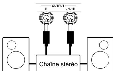
Les prises OUTPUT R et L/L+R permettent de transmettre le son du YPP-100 à un amplificateur d'instrument, une table de mixage, un amplificateur de puissance, ou un appareil d'enregistrement. Lorsque le YPP-100 doit être connecté à un système de sonorisation mono, n'utilisez que la prise L/L+R. Lorsque la prise L/L+R est utilisée seule, les signaux du canal droit et du canal gauche sont combinés et sortis par la prise L/L+R de sorte que vous ne perdez rien du son du YPP-100.
