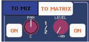
INPUT (입력) 채널의 경우 우측 노브가 2개의 MATRIX (매트릭스) 버스로 공통 샌드 레벨을 조절하고 좌측 노브가 2개의 MATRIX (매트릭스) 버스 사이의 패닝(Panning)을 조절합니다. 좌측 TO MATRIX SEND LEVEL (매트릭스 샌드 레벨로 보내기) 노브를 좌측으로 돌려 홀수 번호 MATRIX (매트릭스) 버스로 보내진 신호의 양을 늘리고, 노브를 우측으로 돌려 홀수 번호 MATRIX (매트릭스) 버스로 보내진 양을 늘립니다.
