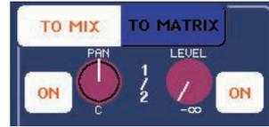
INPUT (입력) 채널의 경우 우측 노브가 2개의 MIX (믹스) 버스로 공통 샌드 레벨을 조절하고 좌측 노브가 2개의 MIX (믹스) 버스 사이의 패닝 (Panning)을 조절합니다. 좌측 TO MIX SEND LEVEL (믹스 샌드 레벨로 보내기) 노브를 좌측으로 돌려 홀수 번호 MIX (믹스) 버스로 보내진 신호의 양을 늘리고, 노브를 우측으로 돌려 홀수 번호 MIX (믹스) 버스로 보내진 양을 늘립니다.
