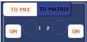
샌드 대상 MIX (믹스) 버스가 VARI (가변) 형식일 경우 TO MIX SEND LEVEL (믹스 샌드 레벨로 보내기) 노브는 SELECTED CHANNEL (선택된 채널) 섹션의 해당 인코더와 동일한 색상으로 표시됩니다. 이 경우 SELECTED CHANNEL (선택된 채널) 섹션의 해당 인코더를 사용하여 샌드 레벨을 조절할 수 있습니다.
