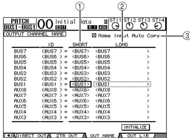
In der mittleren Spalte kann ein Kurzname (①) eingegeben werden; die rechte Spalte (②) erlaubt die Eingabe eines Vollnamens.
