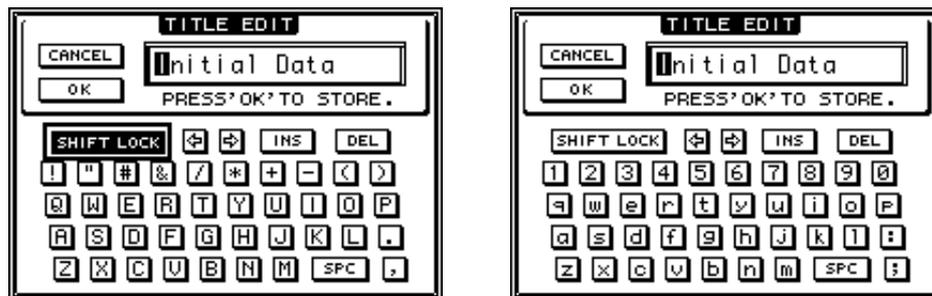
Führen Sie den Cursor zum benötigten Zeichen und drücken Sie [ENTER], um es zum Namenfeld zu kopieren. Der Cursor im Namenfeld springt automatisch zur nächsten Zeichenposition. Mit dem Parameterrad kann man den Namen-Cursor bei Bedarf zu einer anderen Zeichenposition verschieben.
