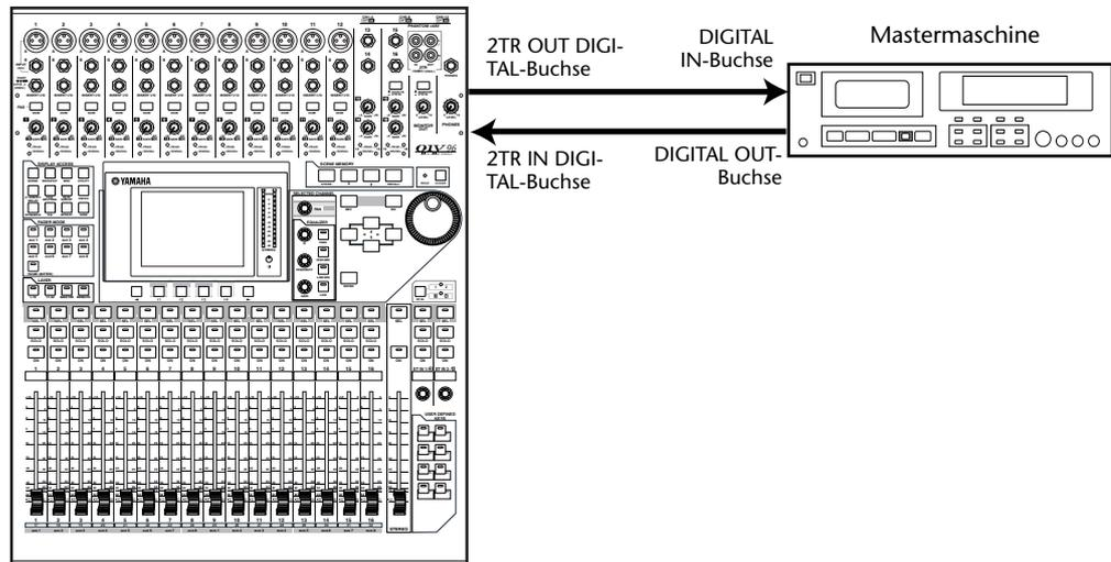
**Tipp:** Für die Überwachung des Aufnahmesignals der Mastermaschine („Nachbandkontrolle“) können auch die analogen 2TR IN-Buchsen des 01V96 verwendet werden. Das Verfahren hat den Vorteil, dass Sie mit dem Wahlschalter des MONITOR OUT-Feldes abwechselnd die Wiedergabesignale der Mastermaschine und des Pultes selbst wählen können.
