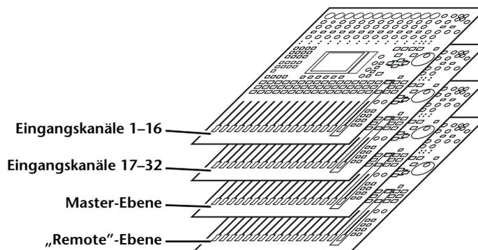
Über die Anwahl einer Mischebene bestimmen Sie die Funktion der Kanalzüge ([SEL]-, [SOLO]- und [ON]-Taster sowie Fader). Die Anwahl muss durch Drücken eines Tasters im LAYER-Feld erfolgen.
