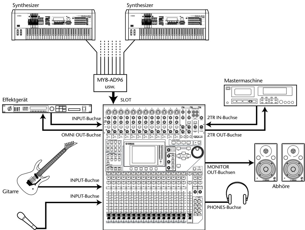
In diesem System dient das 01V96 als Keyboard- oder Beschallungsmischer. Der Slot enthält eine optionale AD-Platine (MY8-AD, MY8-AD96 usw.). Es stehen 24 Kanäle zur Verfügung, die über die Input-Buchsen 1–16 und Eingänge der AD-Platine angesprochen werden.
