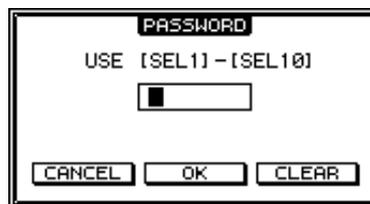
Geben Sie mit den [SEL]-Tastern der Kanalzüge 1–10 ein 4-stelliges Passwort ein ([SEL] von Kanal 10 fungiert hier als „0“). (Die Ziffern des Passworts werden als Sternchen angezeigt.) Führen Sie den Cursor zum OK-Button und drücken Sie [ENTER], um die Riegelfunktion zu aktivieren. Die Werksvorgabe für das Passwort lautet „1234“.
