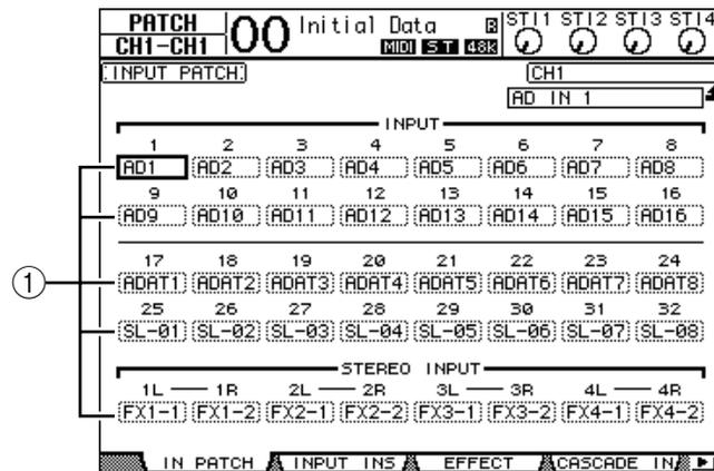
Die Eingänge und Slot-Kanäle, die bereits auf Eingangskanäle geroutet sind, erscheinen in den Parameterfeldern (1) unter den Kanalnummern. Die Anzeigen der Parameterfelder haben folgende Bedeutung:
