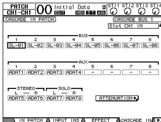
**Achtung:** Wählen Sie auf dem Master-Pult die Busse, die das Slave-Pult auch sendet. Bei Routing-Fehlern funktioniert der Kaskadenbetrieb nämlich nicht.
