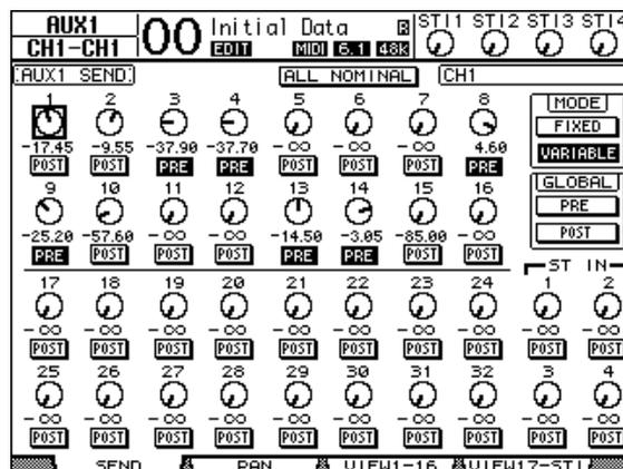
Auch im „Variable“-Modus kann man die Signalausgabe der Eingangskanäle an den gewählten AUX-Weg bei Bedarf unterbinden. Dafür müssen Sie den Cursor zum betreffenden Reglersymbol führen und [ENTER] drücken. (Das dadurch deaktivierte Reglersymbol wird dann grau dargestellt.)
