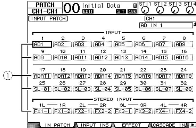
Die Eingänge, ADAT IN-Kanäle und Slot-Kanäle, die bereits auf Eingangskanäle geroutet sind, erscheinen in den Parameterfeldern (1) unter den Kanalnummern. Die Anzeigen der Parameterfelder haben folgende Bedeutung:
