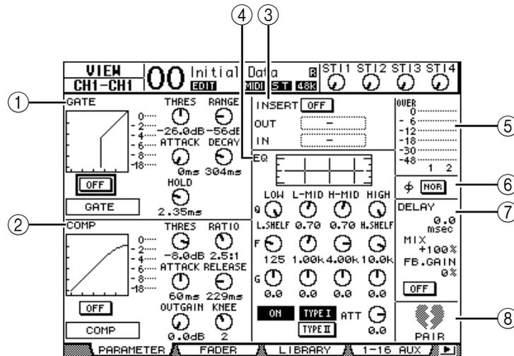
Es stehen folgende Parameter zur Verfügung (Parameter mit einem (\*) sind für die ST IN-Kanäle nicht belegt).
