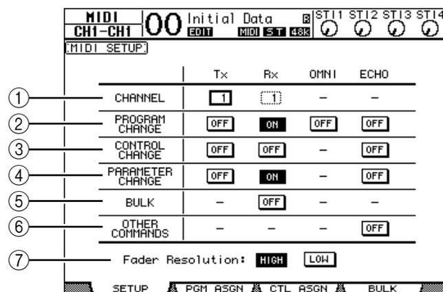
Wählen Sie in der CHANNEL-Zeile den MIDI-Kanal für die Übertragung/den Empfang und geben Sie über die Buttons der Zeilen PROGRAM CHANGE—OTHER COMMANDS an, welche Befehle gesendet/empfangen werden dürfen.
