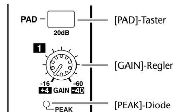
**Tipp:** Mit den [GAIN]-Reglern muss die Eingangsempfindlichkeit eingestellt werden. Im Sinne eines optimalen Fremdspannungsabstands (wenig Rauschen, viel Signal) sollten Sie die [GAIN]-Regler immer so hoch wie möglich einstellen. Vermeiden Sie jedoch Übersteuerung.
