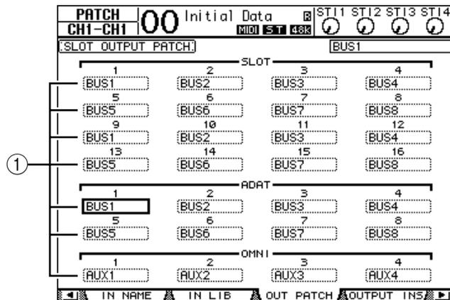
Die Signale, die bereits auf die Ausgänge geroutet sind, erscheinen in den Parameterfeldern (①) unter den Anschlussnummern. Die Anzeigen der Parameterfelder haben folgende Bedeutung:
