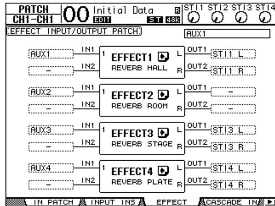
Hier können Sie die Ein- und Ausgänge der Effektprozessoren 1–4 wunschgemäß routen. Laut Vorgabe ist AUX-Weg 1 mit dem internen Effektprozessor „1“ verbunden. Dessen Ausgänge werden an den linken und rechten Kanal von ST IN 1 angelegt (siehe die Abbildung oben).
