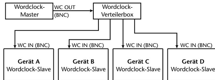
Wenn ein bestimmtes Gerät keine Wordclock-Anschlüsse aufweist, können auch die in den Digital-Audiosignalen vorhandenen Taktinformationen verwendet werden. Dann werden die Audio- und Wordclock-Signale über 2TR OUT DIGITAL übertragen bzw. über 2TR IN DIGITAL empfangen. Als Alternative hierzu können jedoch auch die Digital-Ein-/Ausgänge einer optionalen Platine verwendet werden.
