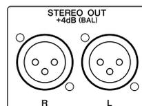
An diesen symmetrischen XLR-3-32-Buchsen liegen die Signale des Stereo-Busses an. Der Nennausgangspegel lautet +4 dB.
