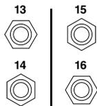
An diese symmetrischen TRS-Klinken kann man Signale mit Line-Pegel anlegen. Wenn der AD15/16-Taster gedrückt ist, werden die an den Buchsen INPUT 15 und 16 anliegenden Signale ignoriert. Dann sind nämlich die an 2TR IN anliegenden Signale auf die Eingangskanäle 15 und 16 geroutet.
