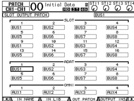
Laut Vorgabe (wie in unserem Beispiel) liegen die Signale der Busse 1–8 am ADAT OUT-Anschluss (Spur 1–8 des Harddisk-Recorders) an. Die Slot-Ausgangskanäle füttern hingegen die Spuren 9–16 des Harddisk-Recorders.
