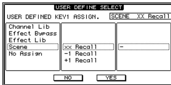
**4 Führen Sie den Cursor zur linken Spalte und wählen Sie mit dem Parameter- rad oder den Tastern [INC]/[DEC] die Funktion, die Sie zuordnen möchten.**
