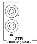
An diese unsymmetrischen RCA/Cinch-Buchsen kann man z.B. die Ausgänge einer Mastermaschine anschließen.
