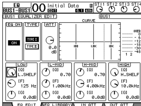
Die Parameter dieser Seite (und das Einstellungsverfahren) entsprechen jenen für die Eingangskanäle (siehe Seite 84). Der STEREO LINK-Parameter ist für den Stereo-Bus jedoch nicht belegt.
