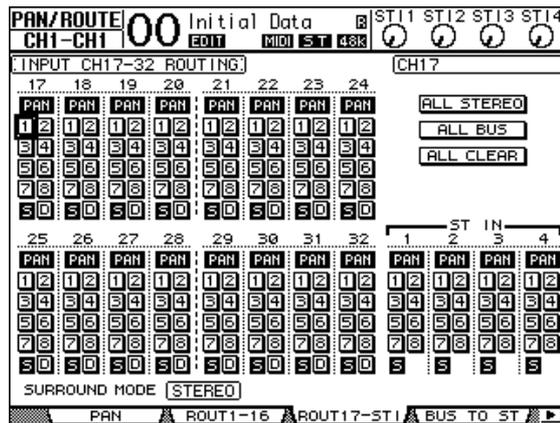
An den Eingangskanälen 17–32 liegen die Wiedergabesignale der Spuren 1–16 (MTR) an. Diese werden in den Stereo-Bus eingespeist und über die STEREO OUT-Buchsen sowie die 2TR OUT-Buchsen ausgegeben.
