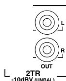
Hierbei handelt es sich um unsymmetrische RCA/Cinch-Buchsen, die man mit den Eingängen eines Gerätes mit Line-Pegel (beispielsweise einer Mastermaschine) verbinden kann. Hier liegen immer die Signale des Stereo-Busses an.
