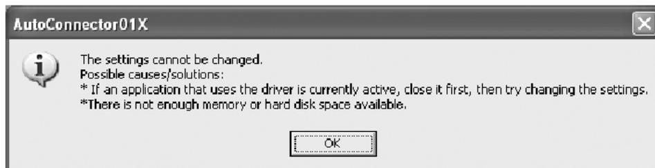
**Ao usar o driver mLAN com um software de áudio, as configurações do mLAN Auto Connector e do Driver Setup não podem ser modificadas, e o software mLAN Applications for YAMAHA/mLAN Tools 2.0 não pode ser desinstalado. Execute estas operações somente após fechar todos os aplicativos.**
