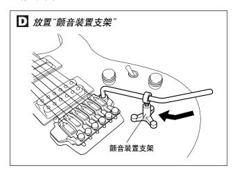
\* 放置"颤音装置支架"时,请旋转其顶部调节高度,使颤音装置与 吉他上部保持平行。(图 **三**)
