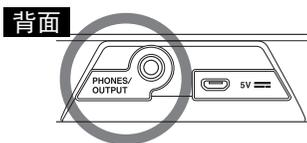
用于连接一副立体声耳机的立体声迷你插头。此插孔还可用作外部输出，用于将本乐器的音频信号发送到外部音频设备。将耳机插头插入此插孔后，本乐器的扬声器将自动关闭。
