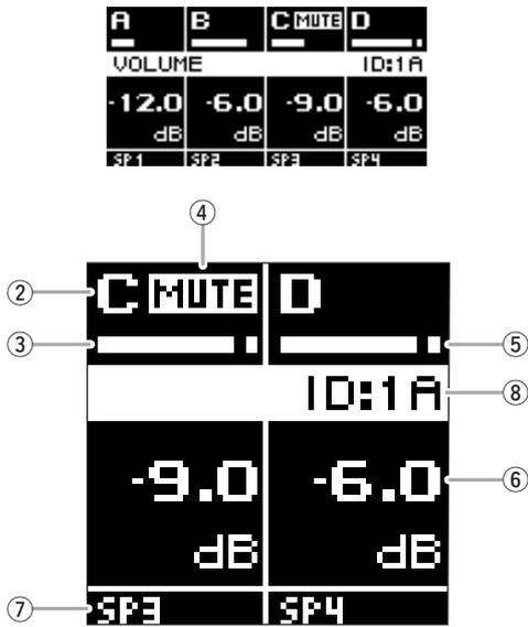
L'écran affiche ② le canal, ③ l'indicateur de niveau, ④ l'indicateur de l'assourdissement, ⑤ l'indicateur d'écrêtage, ⑥ le volume, ⑦ le nom de canal et ⑧ UNIT ID (l'ID d'unité).
