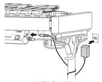
※ DCプラグの抜け防止として、 コードを本体の脚に1回巻き付 けてから接続することをおすす めします。
