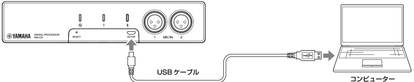
**1. A-microB タイプの USB ケーブルで本製品とコンピューターを接続する**
