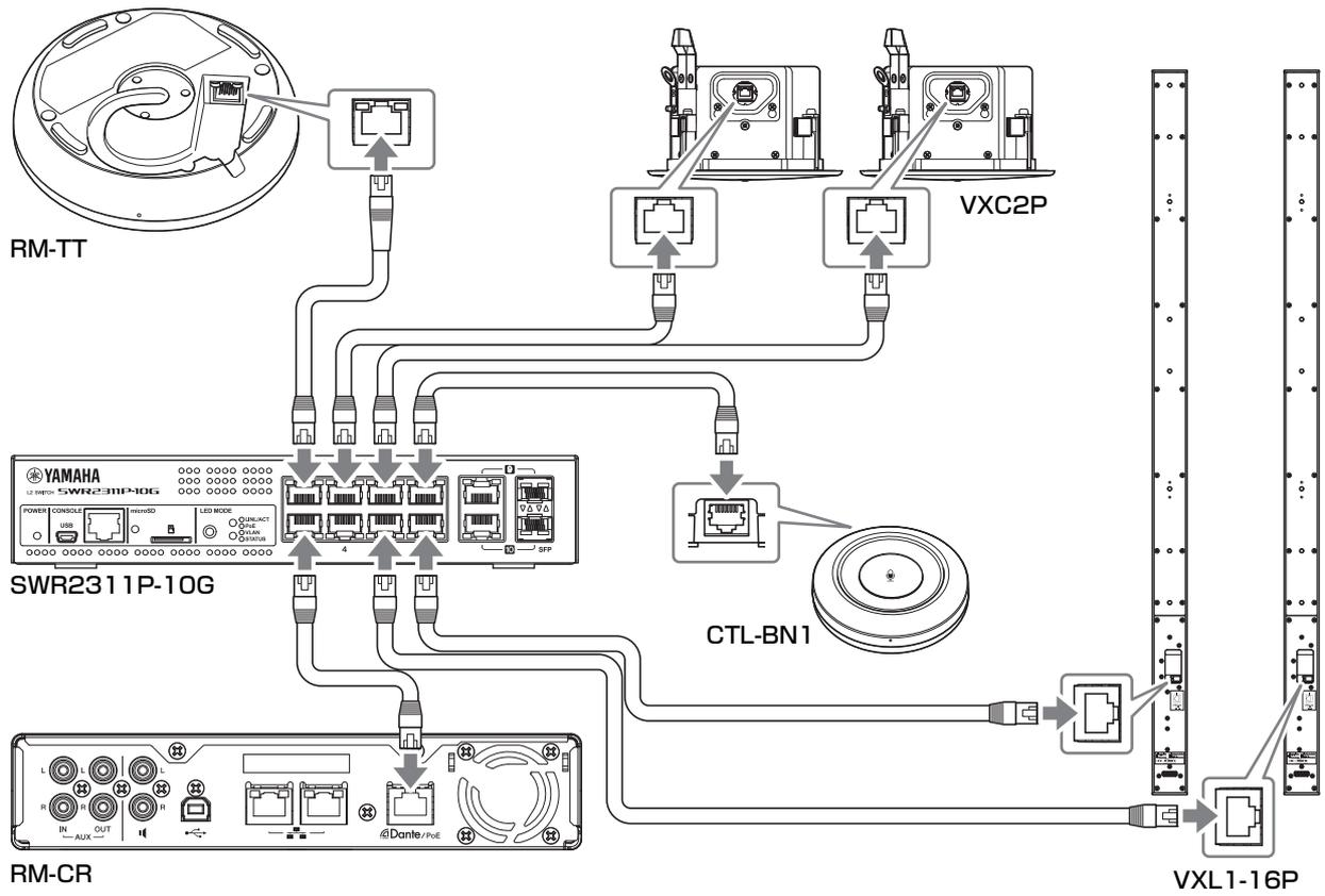
**重要：** VXL1-16 および VXC2P には設定用のディップスイッチが搭載されています。LAN ケーブルを差し込む前に下の図のとおりスイッチの上下を切り替えてください。4 台の設定が一致しないようにする必要があります。
