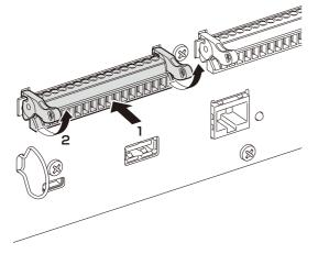
2. 若要斷開 Euroblock 接頭,放下左右鎖扣後拔出接頭。
