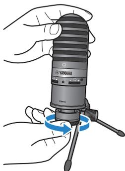
**3 Se necessário, ajuste o ângulo do microfone afrouxando o botão enquanto segura o microfone e, em seguida, reaperte o botão.**
