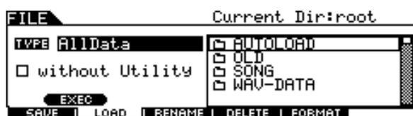
**3** Positionnez le curseur sur le paramètre TYPE, puis réglez le type de fichier sur « AllData » à l'aide du cadran de données ou des touches [INC/YES] et [DEC/NO].
