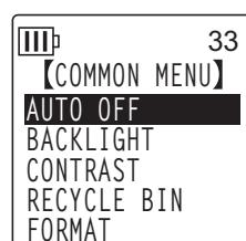
**2. Pulse los botones [◀]/[▶] para seleccionar la hora deseada para que se active el apagado automático y, a continuación, pulse el botón [MENU/ENTER].**
