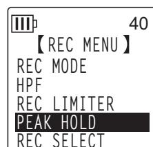
2. Pulse los botones [VOL +/-] para ajustar el tiempo de retención de pico a [INF] (infinito) o a un valor de 0 a 10 segundos y, a continuación, pulse el botón [MENU/ENTER].
