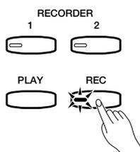
Appuyez sur la touche **RECORDER [REC]** pour activer le mode prêt à l'enregistrement (l'enregistrement ne commence pas encore). Le témoin **[REC]** s'allume.
