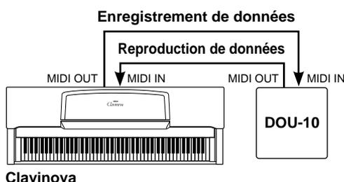
Le même type de transfert de données musicales est utilisé pour effectuer un enregistrement de séquence MIDI. Un enregistreur de séquence peut être utilisé pour "enregistrer" les données MIDI transmises par le Clavinova. Lorsque les données enregistrées sont reproduites, le Clavinova joue automatiquement la séquence enregistrée dans ses moindres détails.
