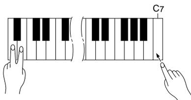
Appuyez sur la touche **C7** tout en maintenant enfoncées les touches **A-1/B-1**, **A-1/A#-1** ou **A-1/A#-1/B-1** pour mémoriser le réglage de hauteur sélectionné. Le réglage sera conservé en mémoire pendant environ une semaine après la mise hors tension de l'instrument, après quoi la hauteur par défaut est rétablie. Pour conserver le réglage plus longtemps en mémoire, mettez l'instrument un court instant sous tension au moins une fois par semaine.
