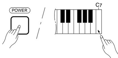
Les réglages de départ d'usine de mode double, réverbération, brillance (CLP-155), sensibilité au toucher et hauteur peuvent être rétablis en maintenant enfoncée la touche **C7** du clavier tout en appuyant sur l'interrupteur **[POWER]** pour mettre l'instrument sous tension. Ceci efface également toutes les données enregistrées.
