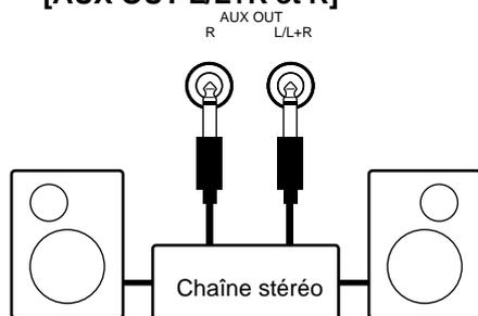
Les prises AUX OUT L/L+R et R permettent de transmettre le son du Clavinova à un amplificateur d'instrument, une table de mixage, un amplificateur de puissance, ou un appareil d'enregistrement. Lorsque le Clavinova doit être connecté à un système de sonorisation mono, n'utilisez que la prise L/L+R. Lorsque la prise L/L+R est utilisée seule, les signaux du canal droit et du canal gauche sont combinés et sortis par la prise L/L+R de sorte que vous ne perdez rien du son du Clavinova.
