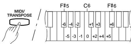
Cette fonction permet de transposer les données transmises par le Clavinova par bonds d’un demi-ton jusqu’à plus ou moins 6 demi-tons. La hauteur du Clavinova lui-même n’est pas affectée.
