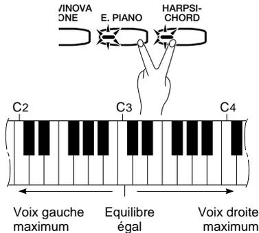
Le volume de chacune des deux voix combinées en mode DOUBLE est normalement réglé automatiquement pour produire un équilibre agréable (voir le tableau "Réglages par défaut" donné ci-après). L'équilibre peut être modifié manuellement, cependant, en utilisant les touches du clavier C2 à C4 tout en appuyant sur les deux sélecteurs des voix combinées en mode DOUBLE.
