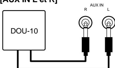
Ces prises ont été prévues essentiellement pour le raccordement d'un module générateur de sons externe, comme par exemple le module Disk Orchestra DOU-10. Les sorties stéréo du module générateur de sons externe sont connectées aux prises AUX IN L et R, ce qui permet la reproduction du son du module externe via les haut-parleurs et le système de sonorisation interne du Clavinova.
