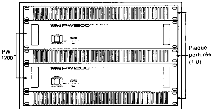
Installation en rack avec ventilateurs de refroidissement
