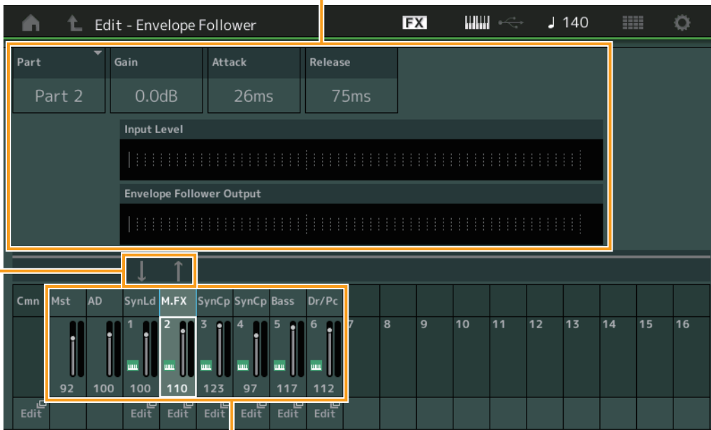
エンベロープフォロワーの 入力信号の流れ
