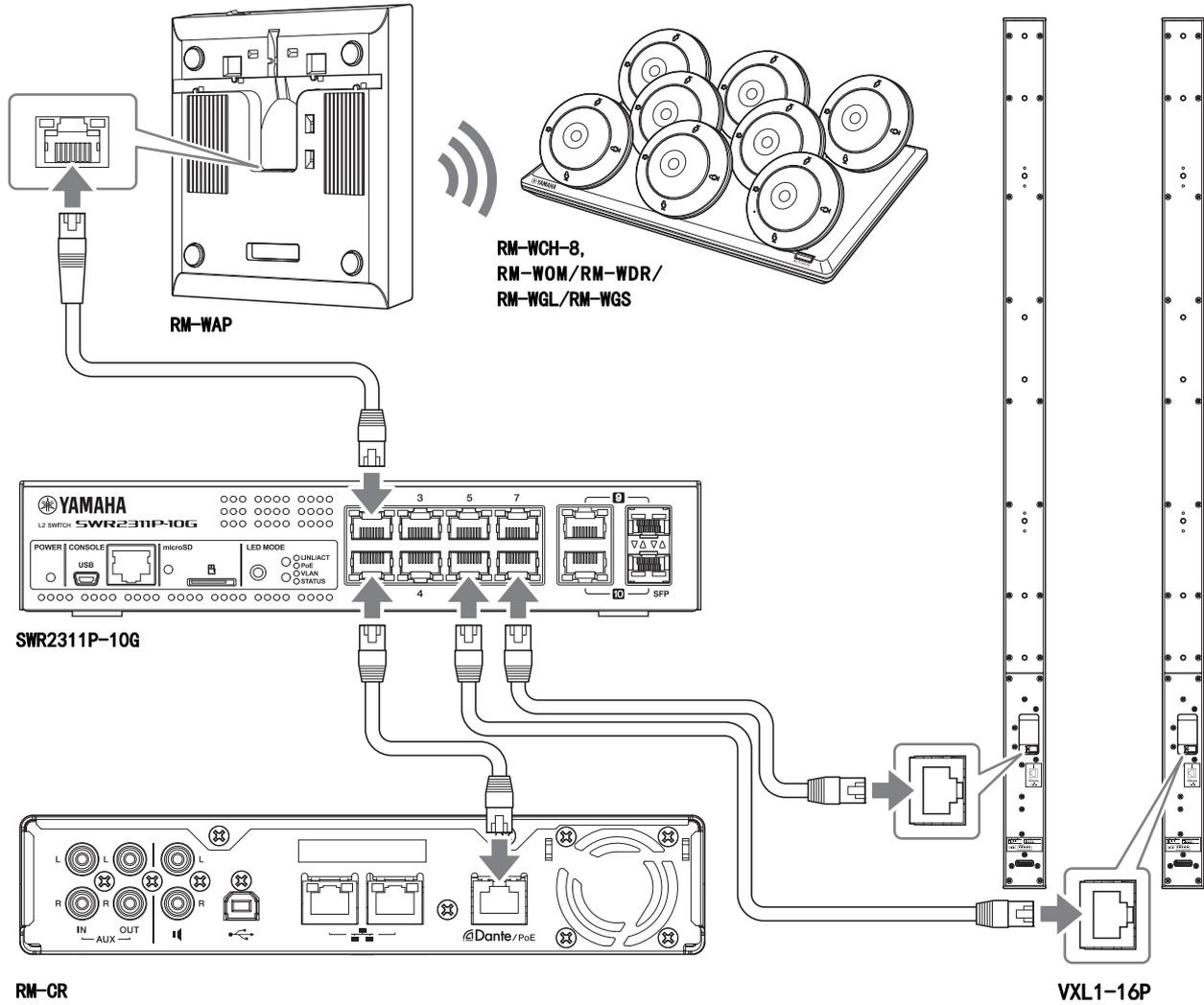
**重要事项：** 每台 VX1-16P 的背面都有一个 DIP 开关，用于指定设置。插入 LAN 线缆之前，按如下所示设置 DIP 开关。两台装置上的 DIP 开关设置不能相同。
