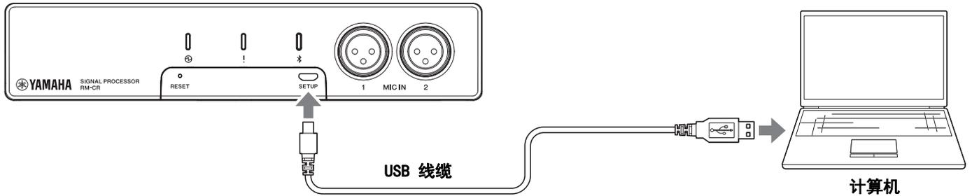
1. 用 A-micro B 型 USB 线缆连接本装置和计算机。
