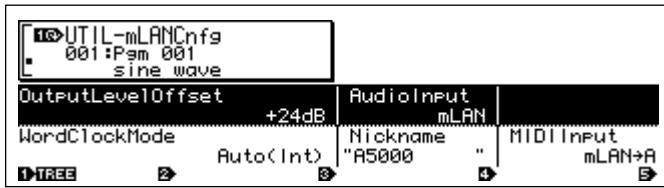
**(NOTE)** Les réglages Output Level Offset (Décalage du niveau de sortie), mode Word Clock (Horloge de mots) et Nickname (Surnom) sont sauvegardés sur la carte mLAN8E. Ils ne peuvent pas être enregistrés sur disque.
