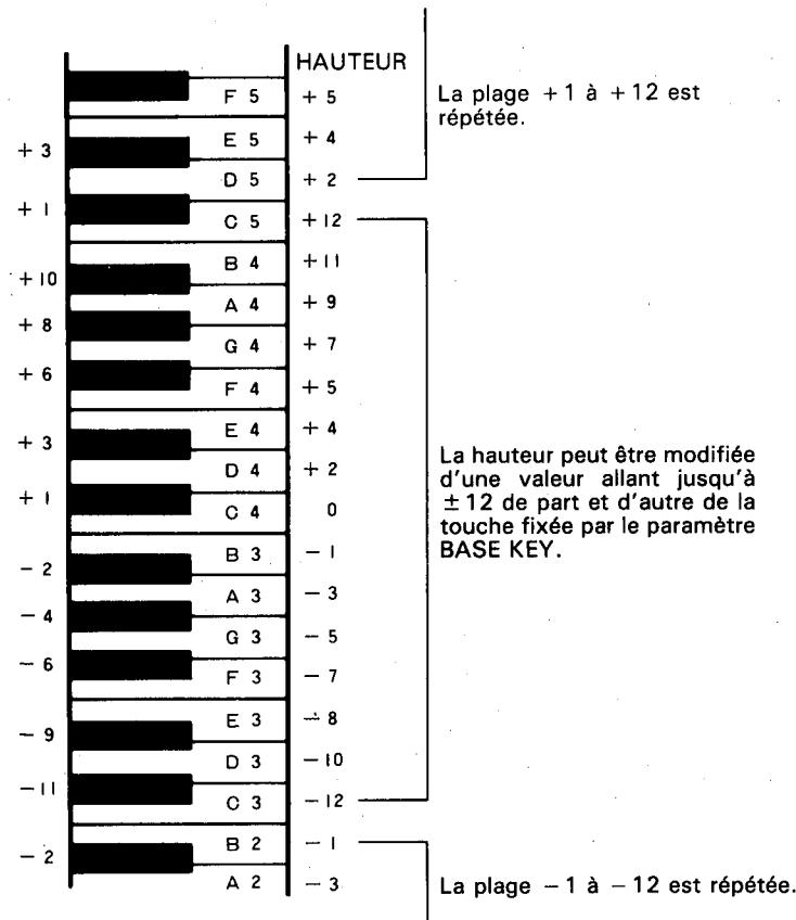
L'effet PITCH B permet de produire, en plus du signal direct, deux notes de sortie dont la hauteur est modifiée indépendamment, ce qui permet en fait de créer des harmonies en trois parties avec une seule note d'entrée. Les deux notes à hauteur tonale modifiée apparaissent au centre du champ sonore stéréo (elles sont envoyées d'une manière égale aux prises OUTPUT L (gauche) et R (droite)).
