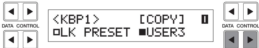
3. Pulse los botones de control de datos de la parte superior derecha para seleccionar la función de copia.
