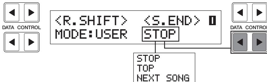
2. Seleccione el tipo de fin de cambio mediante los botones de control de datos situados en la parte inferior derecha. Se encuentran disponibles los tres tipos siguientes:
