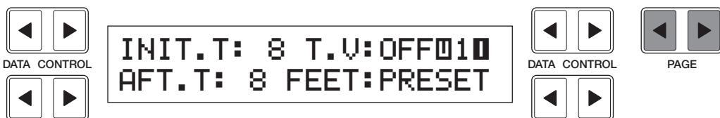
Utilice el par de botones de control de datos de la parte superior izquierda para cambiar el nivel de la voz deseada. En los ajustes de volumen precisos, los niveles disponibles oscilan entre 0 y 24.
