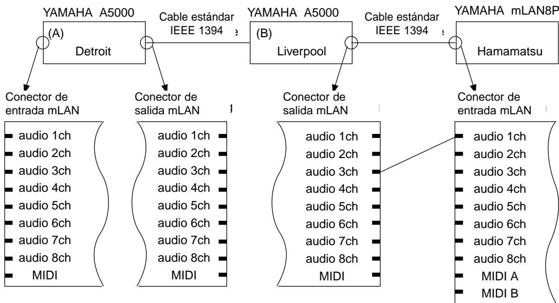
El diagrama anterior muestra un ejemplo de conexión de la señal de salida del canal de audio 3 de un sampler Yamaha A5000 al canal de audio 1 (entrada 1) del procesador mLAN8P. Cada dispositivo lleva un apodo, “Detroit”, “Liverpool” y “Hamamatsu”, de izquierda a derecha.
