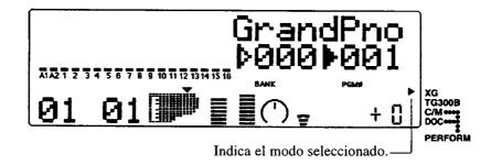
El modo seleccionado se indica mediante una flecha en la parte inferior derecha de la pantalla.
