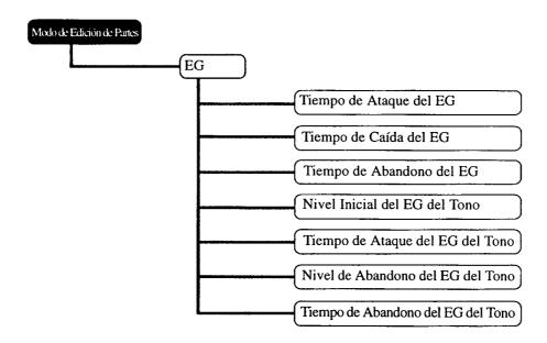
Los parámetros del EG le permiten dar forma al sonido de una Voz de la Parte o, en otras palabras, determinar cómo van a cambiar en el tiempo el nivel y el timbre de la Voz. Esta sección también incluye parámetros PEG (Generador de Envolvente del Tono) independientes, para controlar la forma en que va a cambiar el tono de una Voz de la Parte en el tiempo.
