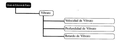
El Vibrato produce un sonido trémulo, vibrante, en la Voz de la Parte, mediante la modulación regular del tono. Se pueden controlar la velocidad y la profundidad del Vibrato, así como el tiempo que se tarda en aplicar el efecto de Vibrato.
