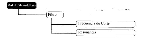
El MU50 incorpora un filtro digital que puede emplearse para cambiar el timbre de las Voces. El filtro se ve afectado (junto con el nivel) por el EG (Generador de Envolvente), lo que también permite cambiar el timbre en función del tiempo. (Véase EG, página 45).
