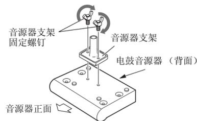
2. 将音源器支架放入管夹中，然后拧紧夹紧螺栓将其固定到位。
