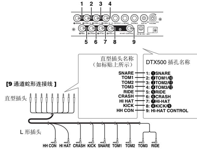
2. 将 9 通道蛇形连接线的 L 型插头插入正确的打击垫。
