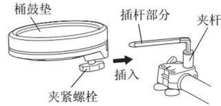
3. 如有需要，可使用夹紧螺栓 A-D 调节任何打击垫的高度和角度。在进行调节时，请务必 1 次调节 1 个螺栓（即，松开螺栓，调节打击垫，重新拧紧，然后松开另一个螺栓）。
