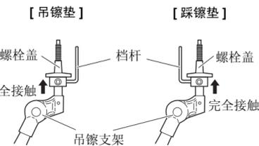
6. 将步骤 2 中拆下的 1 个毡垫放到吊镲支架上。
