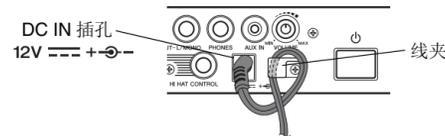
2. 如右图所示，使用连接线箍带将连接线固定到电鼓框架上。（○）
