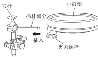
3. 如有需要，可使用夹紧螺栓 A-E 调节任何小鼓垫的高度和角度。在进行调节时，请务必 1 次调节 1 个螺栓（即，松开螺栓，调节打击垫，重新拧紧，然后松开另一个螺栓）。
