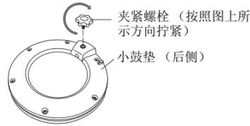
2. 将小鼓垫安装到电鼓框架上的夹杆。如下所示，务必将插杆部分完全插入各打击垫的安装孔，然后完全拧紧夹紧螺栓。
