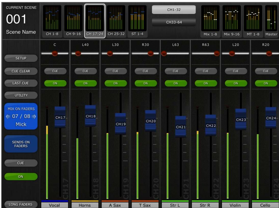
Une large touche [MIX ON FADERS] (Mixage de faders activé) affiche le numéro et le nom du bus Mix actuellement sélectionné. La couleur de cette touche correspond à celle des touches utilisées sur la console LS9.
