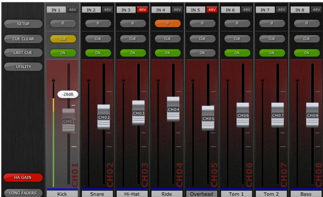
Vous pouvez déplacer les faders pour modifier le gain de préampli micro sur les canaux correspondants. La valeur de gain de chaque préampli micro s'affiche au dessus du fader concerné dès que vous en touchez le capuchon. Il est possible de régler un maximum de 8 faders en simultanément.
