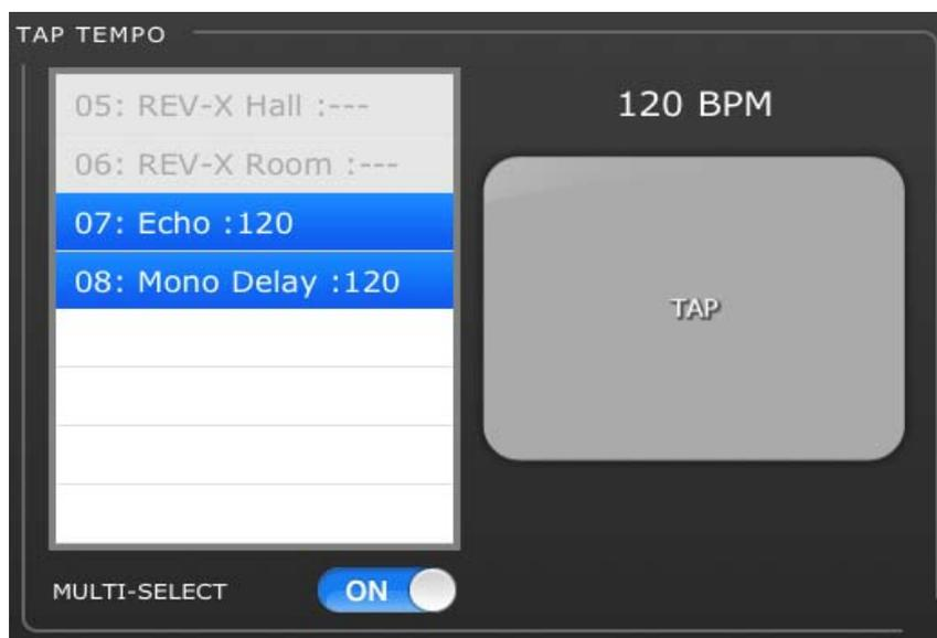
Sélectionnez l'effet pertinent dans la liste des 4 effets située à gauche de cette section. Les effets ne comportant pas de paramètre BPM sont grisés et ne peuvent pas être sélectionnés.
