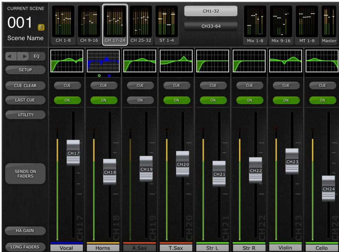
Dans la partie supérieure de l'écran, les indicateurs de niveau et les faders s'affichent par blocs de canaux correspondant respectivement aux canaux d'entrée mono 1-32, aux canaux d'entrée stéréo 1-4, aux bus Mix et Matrix ainsi qu'aux bus master stéréo et mono. Il s'agit de ce qu'il est convenu d'appeler « Navigation/Meter Bridge » (Navigation/Bandeau de bargraphes).
