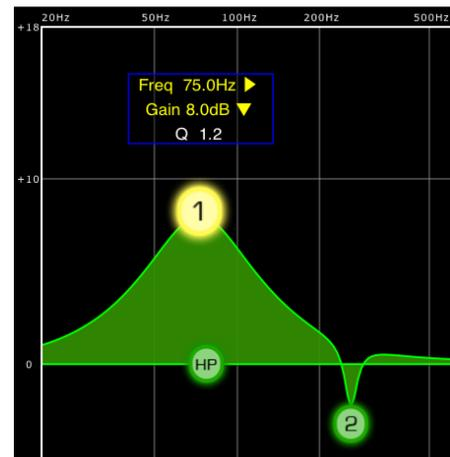
Dans certains cas, il peut s'avérer nécessaire de régler le gain sans changer la fréquence ou d'ajuster la fréquence sans modifier le gain. Dans ce cas, il conviendra d'utiliser les fonctions « Frequency Lock » (Verrouillage de fréquence) ou « Gain Lock » (Verrouillage de gain). Les touches correspondant à ces fonctions sont situées en haut du graphique de l'égaliseur.
