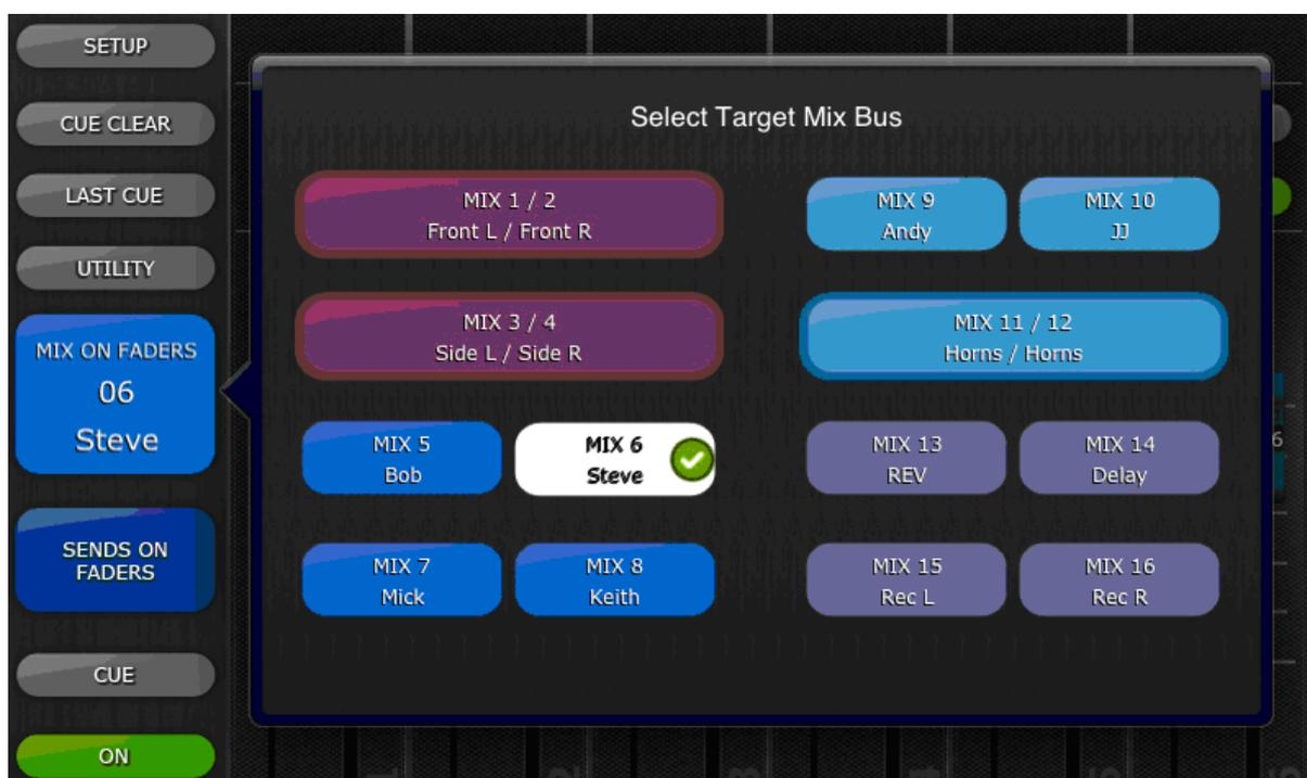
Choisissez le « bus Mix de destination » parmi les bus Mix 1-16. Le bus Mix actuellement sélectionné s'affiche sous forme d'une touche blanche contenant une coche. Les paires stéréo apparaissent sous forme de grandes touches simples (sans coche).
