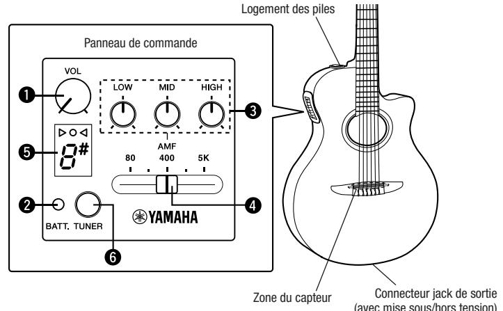
Le préamplificateur intégré est automatiquement mis sous tension lorsqu'un câble est branché dans la prise jack de sortie de la guitare. L'accordeur peut être mis sous ou hors tension à n'importe quel moment.
